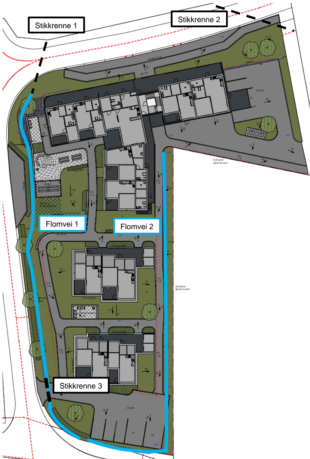
Figur 15 Enkel foreløpig skisse av overvannstiltak. Blå linjer viser flomveier og svart stipla stikkrenner.
