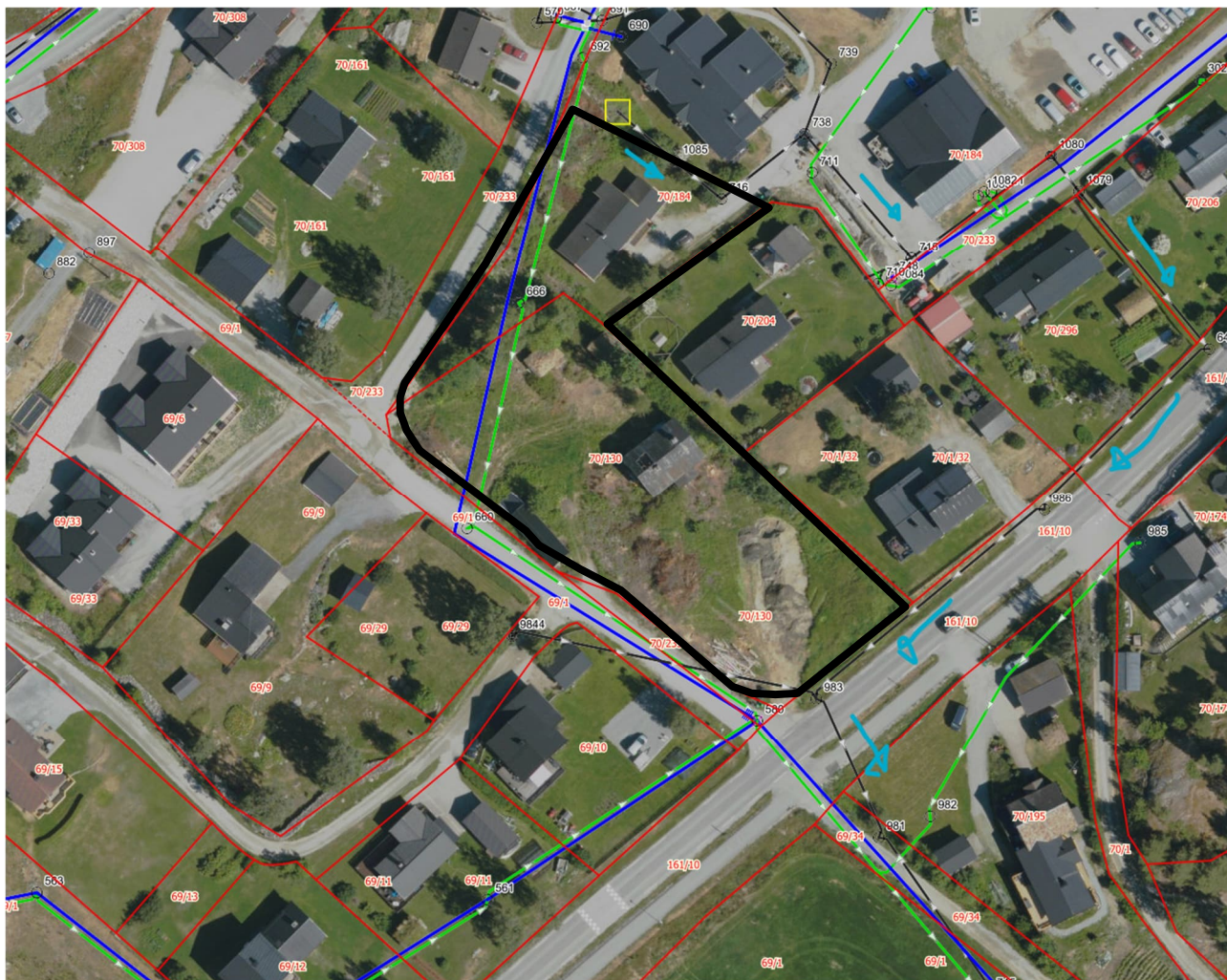
Figur 6 Viser eksisterende VAO over området. Området er markert med svart omriss. Blå piler viser hvor overvannsledningen fra sluket føres og krysser fylkesvegen rett nedstrøms området..
