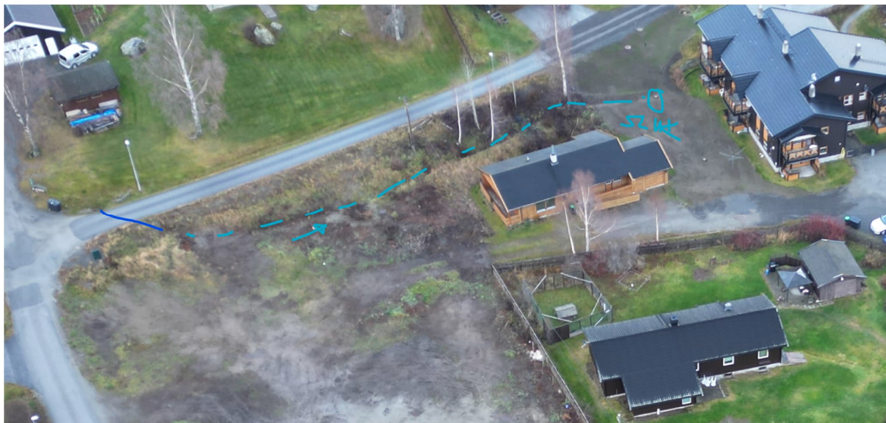
Figur 7 Viser eksisterende overvannsgrøft fra stikkrenne under vegen til sluk/sandfang som føres videre i overvannssystemet.
